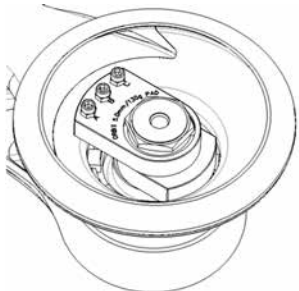
2. Masina konfiguratsioon kaitseketta või vahetallaga kasutamisel.
