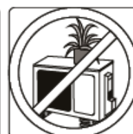
Kontrollera alla luftintag och -utblås för tilltäppning
