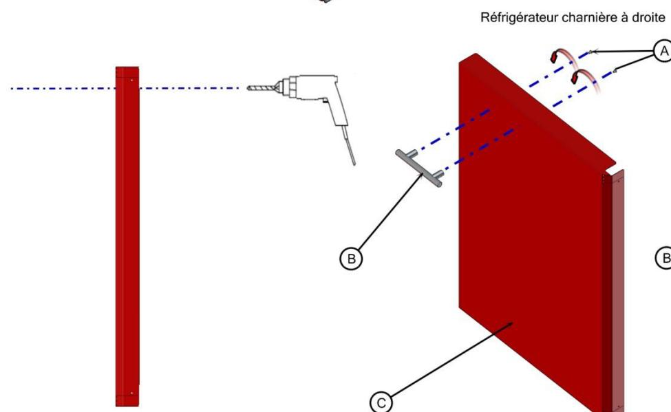
a. Perçage des trous pour la poignée suivant le gabarit de perçage
