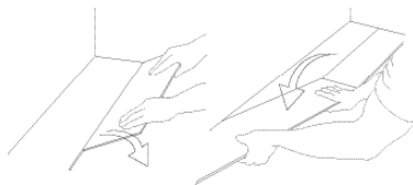
2. LÄGGNING AV ANDRA RADEN.
