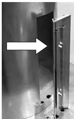
Bild 1. Kontrollera att värmesköldens öppning är på rätt plats.
