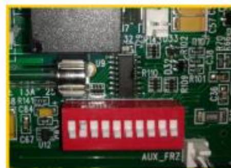
DIP-switch inställning modell Massimo II & Ferrara II: Kontakt nr. 2 ska stå i ON1( upp )
